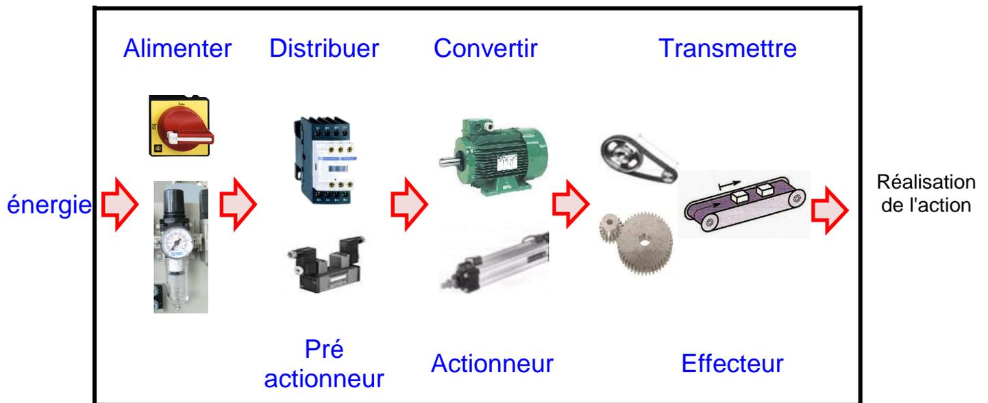
**L'alimentation** : établit l'arrivée d'énergie, adapte, protège le reste de la chaîne, ex : sectionneur, Frl, disjoncteur ....
